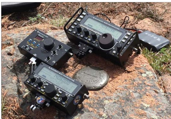
Bild2 – En familjebild hittad på nätet. Här har fotografen lagt KX1, KX2 och KX3 på en sten. Man ser tydligt den inte helt oväsentliga skillnaden i storlek på apparaterna. KX2 har samma display som KX3 (och K3). Bra för tydligt handhavande.
