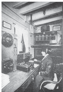
Bilden visar Ms Packer vid telegrafnyckeln på SS Mohawk 1910. Apparaturen är en 3 kW gniststation med Coherer mottagare. Hon blev senare advokat och medlem av Oklahoma State Bar Association.
