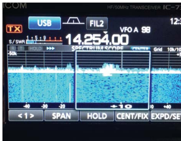
Bild 6: Radions display är kanske inte stor med sina 11 cm på diagonalen. Tydligt och lättläst är det dock. Inte bara i färg utan även tryckkänslig så att man likt en mobiltelefon kan navigera med fingrarna. Vattenfallet kan anpassas i storlek och omfattning beroende vad man vill se. Här har ett utsnitt visats för att visa hur man kan "zooma" in på stationen att lyssna på.
