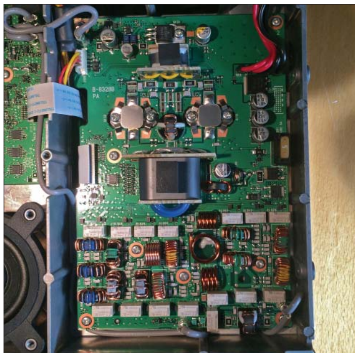
Bild 4: Sändarens förstärkardel ser ut som i vilken radio som helst. Här ser man även lågpasfilterna i nedre delen på bilden. Snyggt och prydligt är det onekligen.
