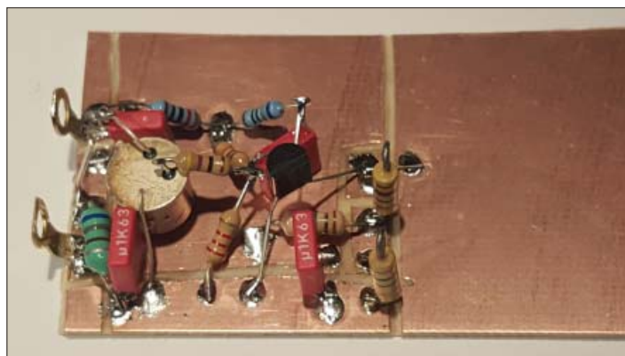
Bild 4 – Här är förstärkaren klar för test och sedan inbyggd i sitt skyddande hölje. Proben (antennen) till höger i bild. Bygget är gjort "ugly style", har alltså en amatörbyggd charm som det inte går att ta fel på.
