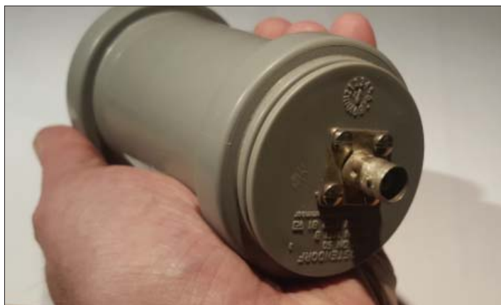
Bild 1 – Här den färdiga lilla aktiva bredbandsantennen i näven. En dubbelmuff för 50 mm avloppsrör med en plugg i båda ändar. Ett prydligt och enkelt egenbygge.
