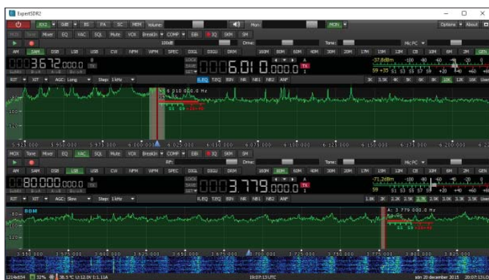
Bild 7: Här har en extra mottagare (RX2) kopplats in. Som framgår av bilden så kan man lyssna på två band samtidigt. Gränssnittet är inte bara intuitivt, ser snyggt ut också.
