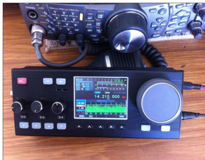
Bild2: På bilden ser man ett exempel på hur man kan gestalta lådan. Som framgår så har byggaren ännu inte ordnat med texter vid respektive knapp. I bakgrunden ser man en TS-2000 från Kenwood för storleksjämförelse.
