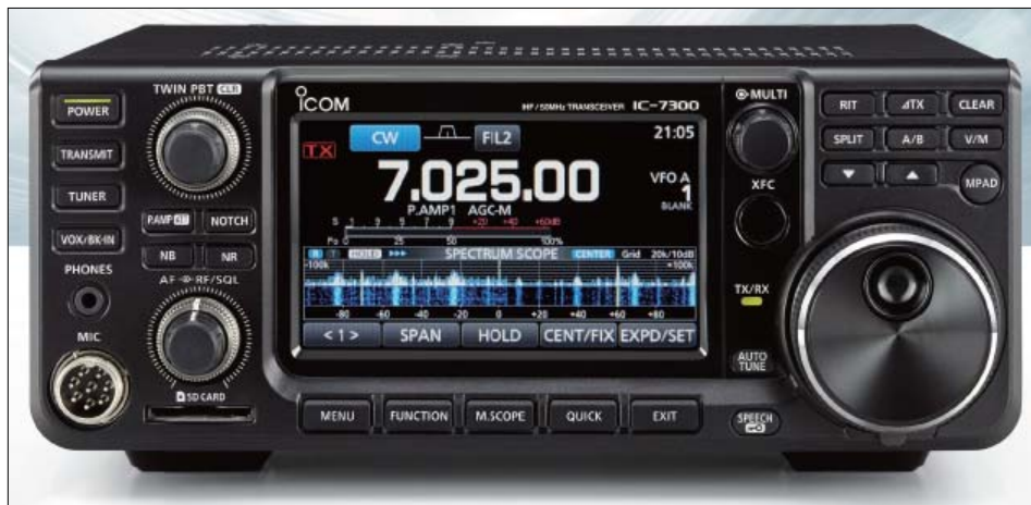
Bild 1. Så här skall den se ut, den nya IC-7300 från ICOM. Kul att man har fått in så mycket intressant teknik i en paketering som är användbar för riktigt många. Till och med en automatisk antenنانpassare finns med, utmärkt kanske framförallt i fält.
