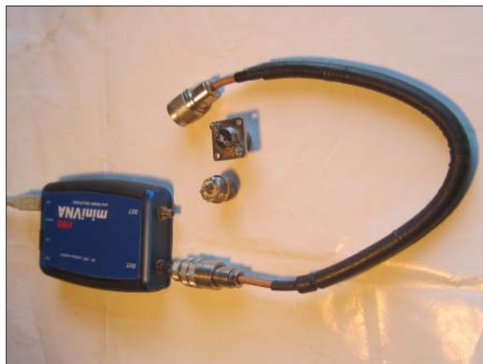
Bild 2, för SWR-mätning: SMA-PL adapter, 50 Ω Teflonkabel med 50 st "Ferrite Beads" FB-73-2401 och mina hemgjorda kalibreringskontakter med 50 Ω respektive kortslutning.
