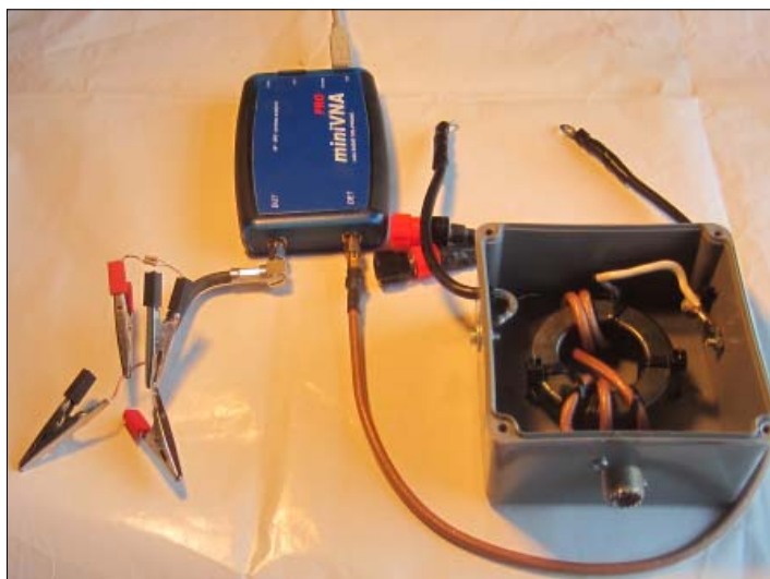
Bild 1, mätning av CMC, notera motståndet R med krokodilklämmorna. BALUNen är gjord för 21 – 28 MHz med 2x2 varv Teflonkabel på Ferrit-Toroid FT240-43. För 10 – 14 MHz använd 2x4 varv och för 1,8–7 MHz FT240-31 med 2x5 varv. Denna BALUN hade mer än 30 dB = 1500 Ω CMC-dämpning på 28 MHz. Mätresultatet hade blivit bättre om jag tagit ut BALUNen från lådan.
