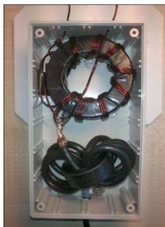
Antennbox med Choke W1JR på FT140-43 + Bootstrap-trafo på FT240-61 lindad med 1,2 mm Cu-tråd.
