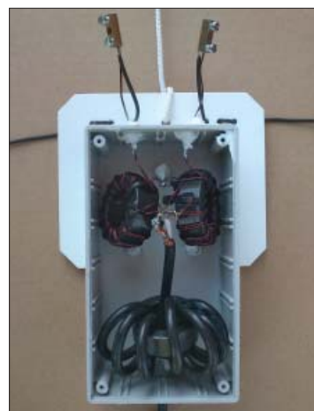
Antennbox med Choke W1JR på FT140-43 + Guanella-trafon på FT140-61 lindad med 1mm Cu-tråd.
