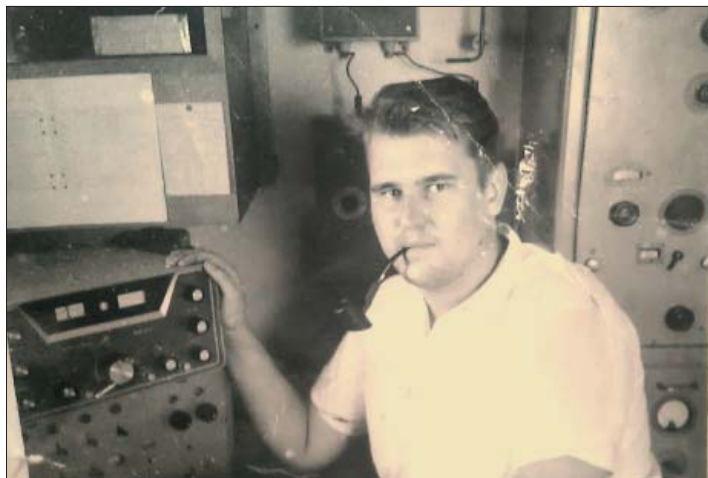
Rikard SM1CQA som ung fartygstelegrafist på Markland. Bilden från 1961. Mottagaren är Rikards egen Hallicrafter SX 117, som han köpt i Singapore. Den mottagaren som radiohytten var utrustad med var instabil och kunde ibland hoppa 15 Kc under ett sändningspass.
