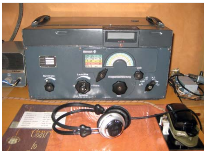
En av mottagarna är den tidens hightech Telefunken Köln som är byggd med moduler och ett system som vi skulle kunna efterlikna. I denna apparaten finns ingen rättboteknik utan ser snyggt ut.
