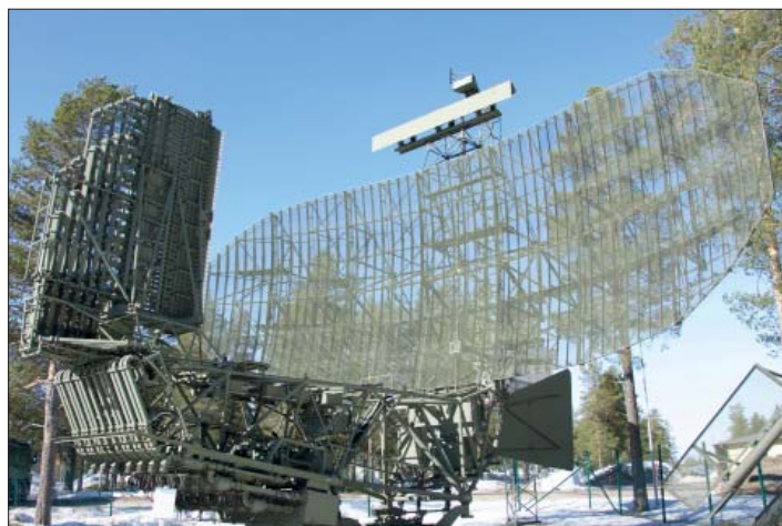
Storradaskärm till en PS-66 T för luftövervakning.
