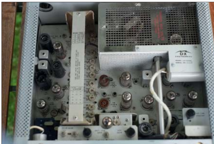
Bild 3: They dont do radios like this anymore.... Överallt stöter man på "hederlig teknik" då man lyckat på locket. 18 elektronrör och faktiskt några halvledardioder är alla dom aktiva komponenterna. Jämför gärna med första bästa radio idag som har fullt med IC:s
