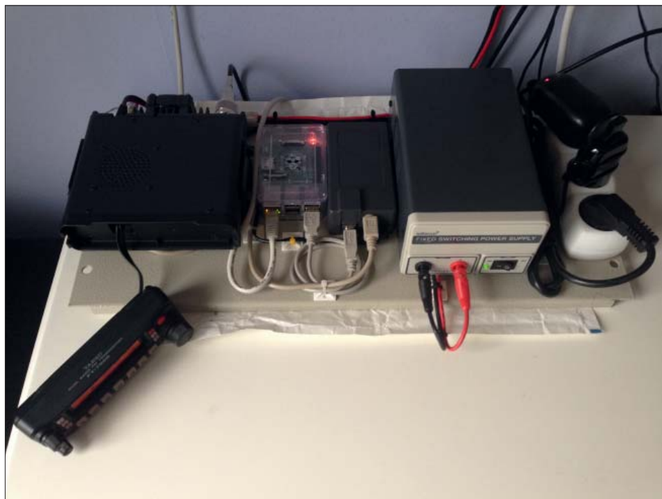
Bild på hotspotten med radio under provkörning då den låg till modul DCS010S – Repeater-Hotspot tests, för att inte störa andra om något skulle fallera.
