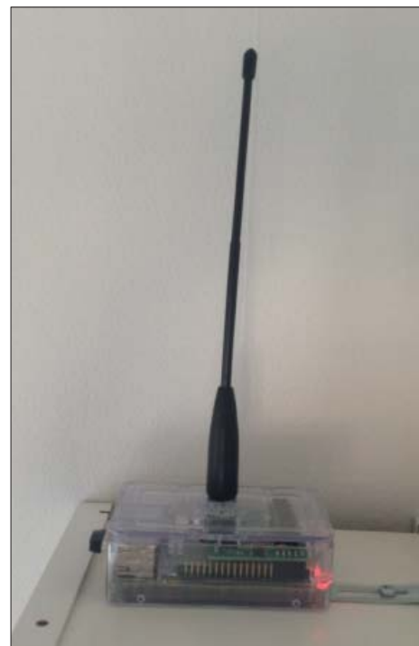
Bild på hotspotten med radio under provkörning då den låg till modul DCS010S – Repeater-Hotspot tests, för att inte störa andra om något skulle fallera.
