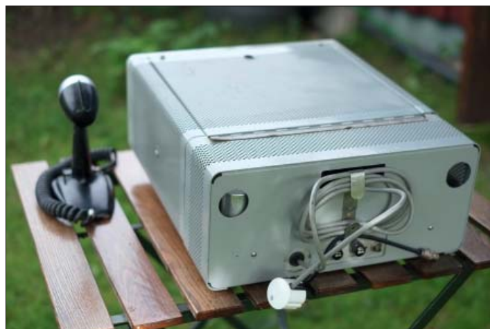
Bild 2: Tittar man på radions baksida ser man det påmonterade LightWeight Power supply. Det är svårt att inse att detta är en 100 W radio och inget mera. Jämför gärna med en liten mobilradio för kortvåg av dagens mått mätt. Inkoppling antennen och andra signalkällor på baksidan måste göras då nätdelen inte är inkopplad. Ganska böjigt...
