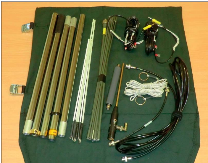
Bild 4. Egenkomponerat antennkit för 10–28 MHz banden komplett med mast och matarkabel.
