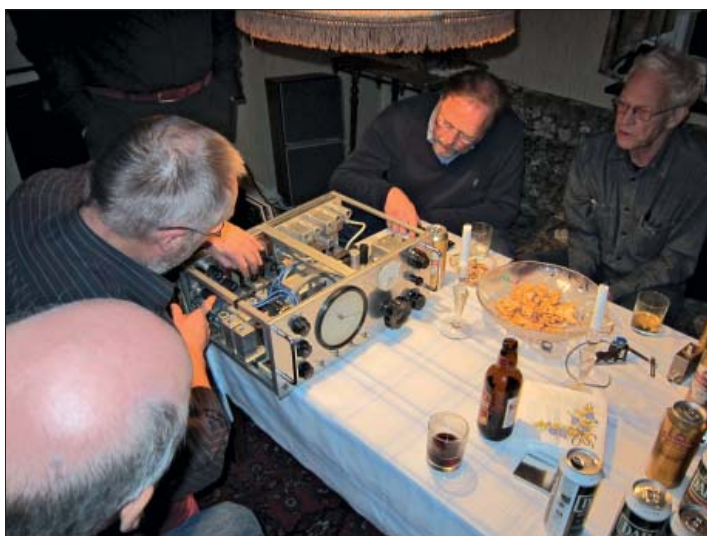
Den av SM7ZN byggda rörbestyckade mottagaren för kortvågsbanden samt 144 MHz.
