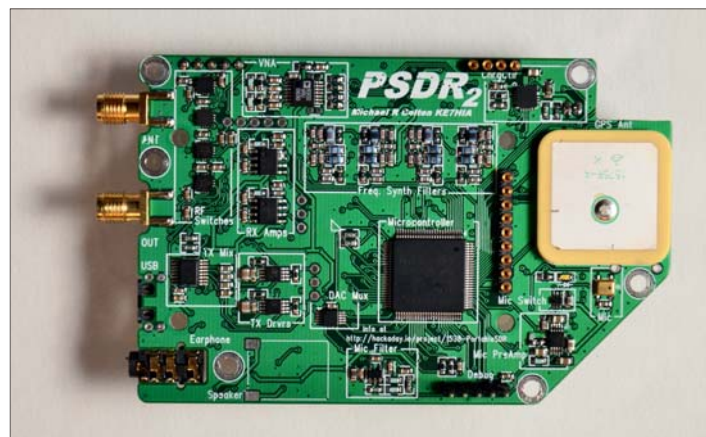
Fig 2: Tittar man på kretskortet så ser man att konstruktören har delat in kortet i dom olika modulerna. Inte för att man kanske kommer att vilja bygga den ytmonterade konstruktionen. Utan för att det skall bli lite mera lättbegripligt. Bild från hemsidan.
