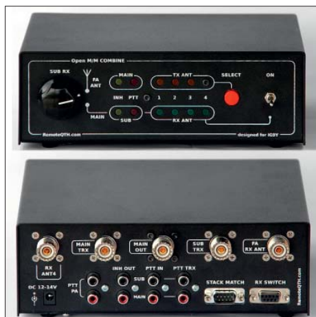
Figur 4. Open M/M Combine från www.remoteQTH.com . Boxen går att använda för inband-körning. Dessutom finns möjligheten att utöka funktionaliteten med styrning av flera antenner. När man använder en sådan här box är det viktigt att låta PTT-signalen styra omkopplingen mellan sändning och mottagning för att det skall bli rätt funktion.
