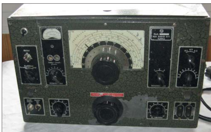
VRLK Veera mottagare 230–20200 kHz som användes av den Finska signalspanningen. Mottagaren tillverkades av ASA Radio i Finland och är en kopia av National NC100.
