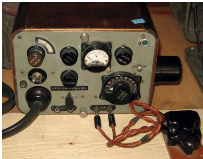
SEVER VRHV sändare/mottagare 2500–6800 kHz. Tillverkad i ryssland och användes av ryska spioner i Finland under kriget.
