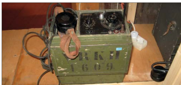
6PK rysk sändare/mottagare 2750–5500 kHz. Finska armén erövrade mängder av rysk materiel under vinterkriget.
