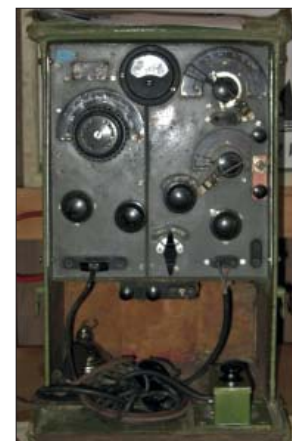
6PK rysk sändare/mottagare 2750–5500 kHz. Finska armén erövrade mängder av rysk materiel under vinterkriget.
