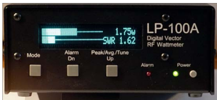
Fig 1: Grafisk presentation (och digital) av uteffekt och stående våg. Få knappar på fronten går åt för att manövrera enheten. Uteffekten kan även presenteras i dBm.
