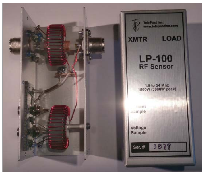
Fig 3: Så här ser proben ut om man lättar på locket. En helt vanlig mätbrygga med två induktanser (toroider) över signalledning (koax). Utsignal (ström och spänning) till huvudenheten tas ut från sidan via vanliga koaxialkablar. Kabellängden får inte var för stor.
