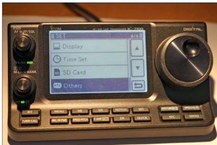
Figur 3 och 4: Menyerna och dess undermenyer är grafiskt presenterade och ger genom detta ett mera logiskt och lättanvänt sätt än ofta kryptiska förkortningar i andra menysystem vi är vana vid. Det går att peka och "klicka" med fingret. Men att svepa och nypa som på smarta telefoner fungerar inte.
