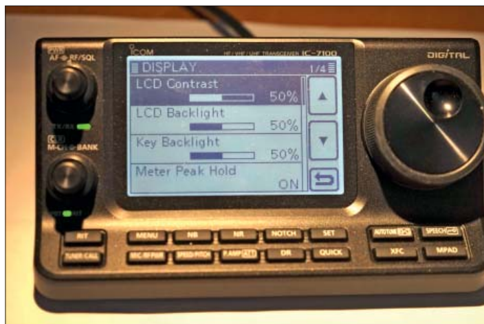
Figur 3 och 4: Menyerna och dess undermenyer är grafiskt presenterade och ger genom detta ett mera logiskt och lättanvänt sätt än ofta kryptiska förkortningar i andra menysystem vi är vana vid. Det går att peka och "klicka" med fingret. Men att svepa och nypa som på smarta telefoner fungerar inte.
