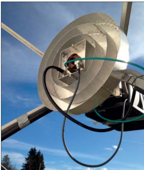
Converter byggd för att passa inuti 23 cm mataren. Kablarna är spänningsmatning, LO och IF.
