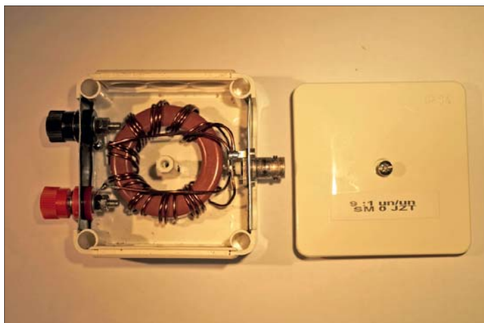
Fig 4: Det färdiga resultatet i sin elkopplingsdosa. Kontakterna har monterats i plåttbitar nedstuckna i gavlarna eftersom kopplingsdosans sidostycken är av mjuk plast. Välj den inkapslingslösning som passar dig bäst.
