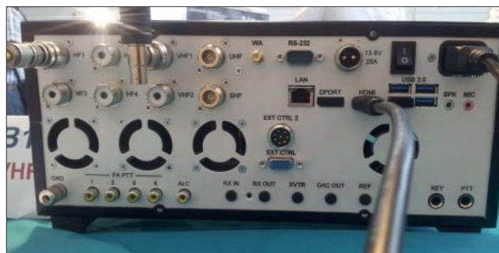
Baksidan av SunSDR-MB1. Av alla kontakter att döma, så verkar man ha tänkt på precis allt. Foto SM5AJV.
