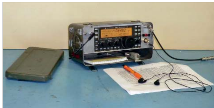
Transceivern Elecraft KX3 monterad i en batterilåda för Ra200 med gott om plats för LiFe-batterier, diverse småtillbehör som till exempel en läsplatta eller en liten laptop.
