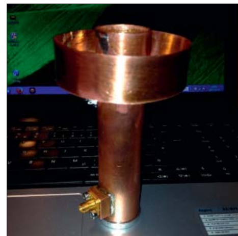
Linjärt polariserad Kumar feed. I mitt fall orienterad för horisontell polarisation.
