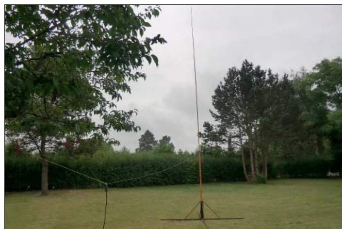
Koaxialdipolen uppsatt 1,7 m ovanför gräsmattan.
