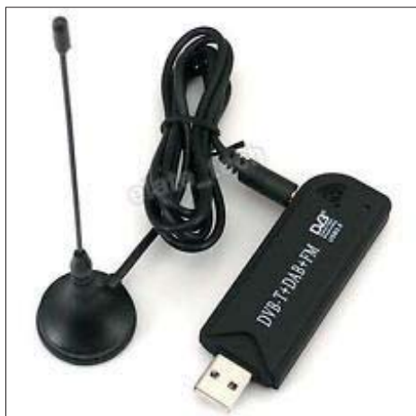
Fig 1 – Så här ser pinnen ut som användes till denna artikel med höljet på. Det finns flera som har RTL2832U-kretsen.
