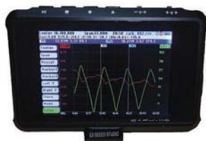
SARK-110 Antennanalyator 100Khz-230Mhz med bla Smithdiagram
