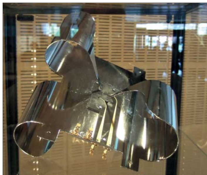
Dual Polarized Self-grounded Bowtie Antenna. Läs mer om denna antenn på: www.gapwaves.com
