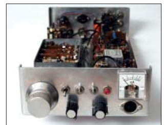
Innanmätet på 3 watts tranceivern. Den hembyggda VXO:n syns nertill på bilden. Börjar med en 7,5 MHz kristall, sedan två tripplare och en dubblare till 135 MHz. Till höger om den BFO:n och till vänster Lf förstärkaren-
