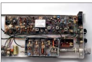
Innanmätet på 3 watts tranceivern. Den hembyggda VXO:n syns nertill på bilden. Börjar med en 7,5 MHz kristall, sedan två tripplare och en dubblare till 135 MHz. Till höger om den BFO:n och till vänster Lf förstärkaren-
