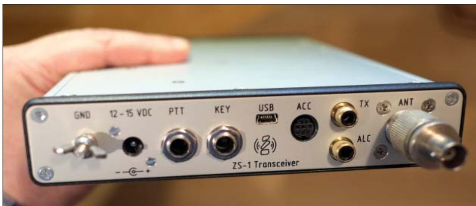
Bild 2, på riggens baksida sitter ett par kontakter. I mitten del lilla USB-kontakten som kopplas till en PC för styrning. Se texten för detaljer.
