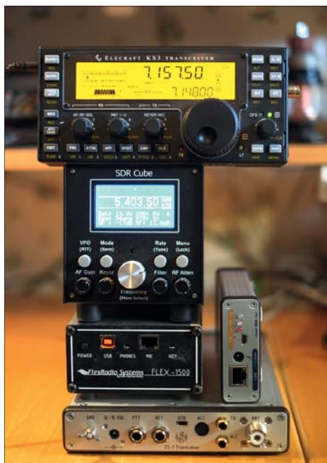
Bild 1, ZEUS ZS-1 längst nere i högen bland ett par SDR-kusiner. Den ser inte mycket ut för världen trots att den har den absolut bästa prestandan i sällskapet. Alla är transceivers förutom den lilla AFEDRI-mottagaren på högkant.
