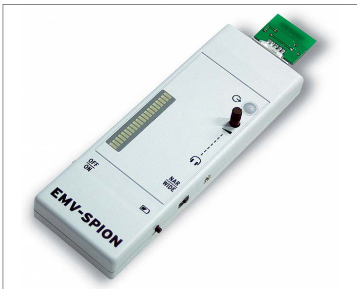
"Instrumentet – här i färdigt utförande är behändigt litet att ha med ute i fält för att på ett smidigt sätt leta rätt på störkällor. Dom 20 lysdioderna till vänster på lådan indikerar styrkan. På höger sida ansluter man en hörlur för att få ljudlig hjälp för identifiering. På ena kortsidan anslutes lämplig prob/sensor."
