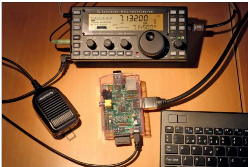
Som synes trivs den lilla raspberryn mycket gott i sällskap med en radio som en ELECRRAFT KX3. Här har den lilla datorn stoppats in i en genomskinlig ask. Den tjocka HDMI-kabeln går till PC-skärmen. Den tunna går till en enkel nätdel med micro USB-kontakt på 5V / 1A. Tangentbordet nere till höger kopplas trådlöst via USB, så även kopplingen till Internet via WiFi.
