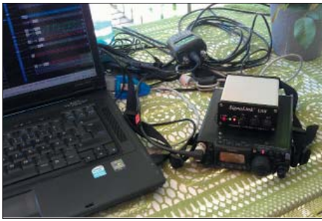
SJ7SOP-6 QRP set-up för PSK.
