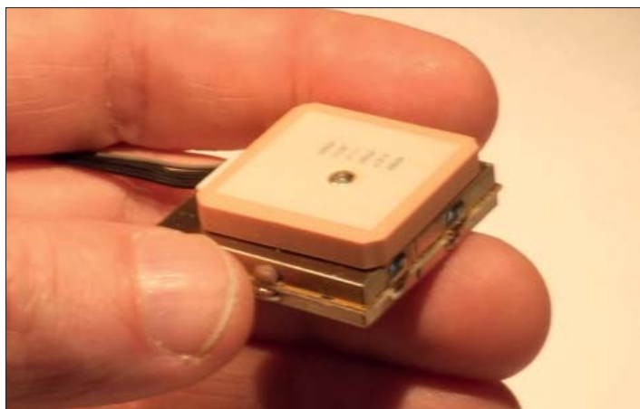
GPS-mottagaren är inte någon stor klump utan göms lätt i en hand. Den är inte kapslad utan placeras med fördel i en icke skärmande låda. Antennen ser man på toppen av modulen i bild. Detta är en NAVILOCK EM406A-modul som bland har 1PPS utgång.
