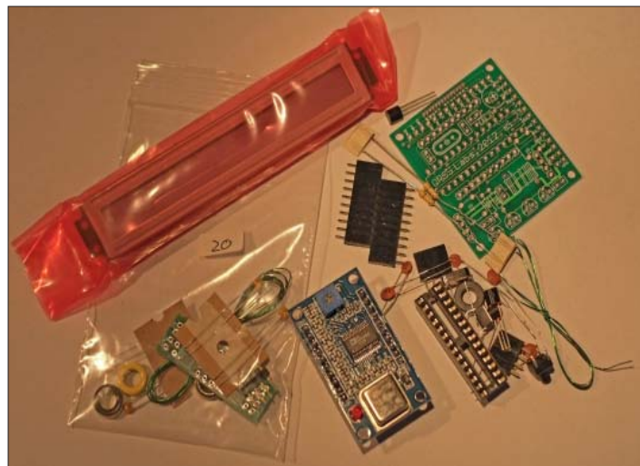
Det är inte många komponenter som ingår i byggsatsen att montera. Allt är hålmonterat. Som framgår av bilden så är dom ytmonterade komponenterna redan på plats på DDS-modulen med sin AD9850-krets.
