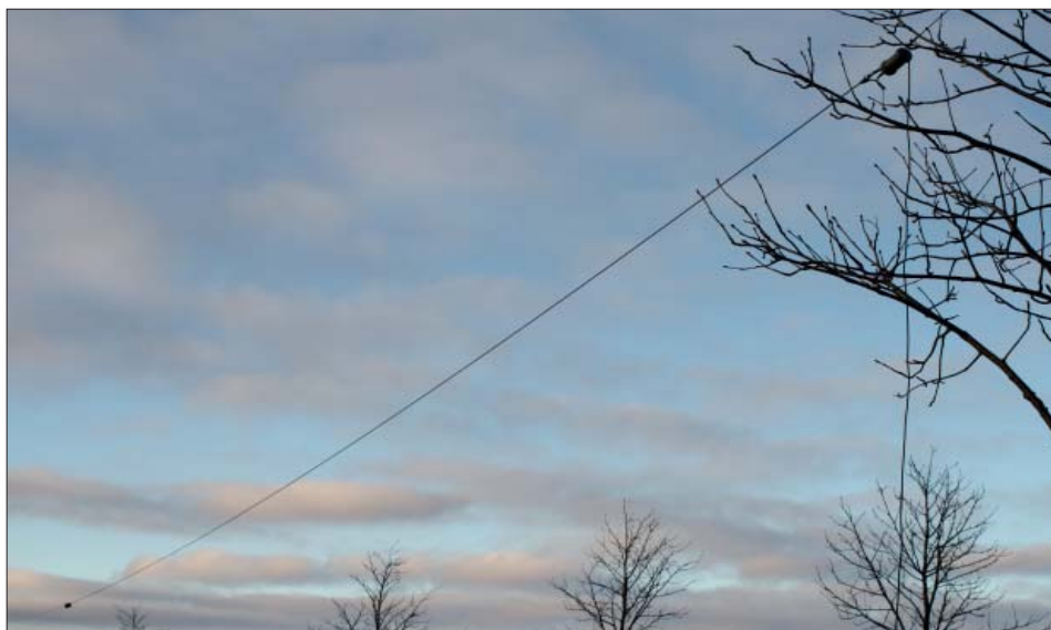
Antenner på bild brukar vara svårt att se. Ett tränat amatöröga ser dock antennen mot en vacker himmel, här är uppspänd mot ett litet träd till höger i bild. Strömbalunen syns i trädkronan och matarkabeln går ner vertikalt mot backen. Tittar man nere till vänster i bild ser man spartrafon i sitt muffrör. I bilden ser man alltså "bara" 1/3-del av antennen som ju består av koaxdelen.
