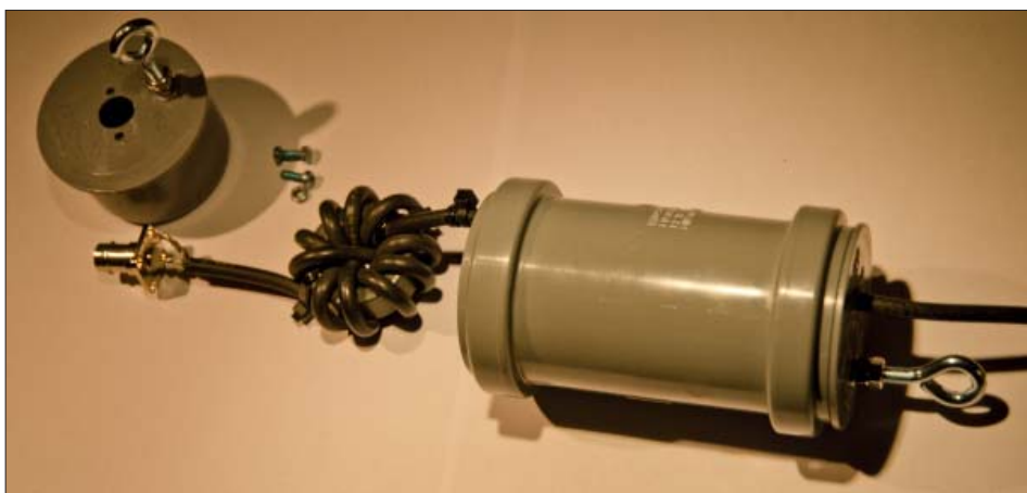
Strömbalunen är klar att montera i sin skarvmuff (50 mm). Notera att det är lite trångt att få in 10 varv (2 x 5) på ringkärnan. BNC-kontakten skruvas fast med två skruv och dragögglor monterats bortom lockets mitt så att balunen hänger ned och eventuellt vatten kan tränga ut genom litet hål i muffens botten. Försegla gärna koaxingången med exvis varmlim. På bild har stoppskruv ännu ej monterats för att stoppa locken från att glida ur muffen.
