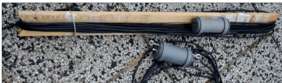
Ett tips på vägen då portabelantennerna skall samlas ihop. Linda upp tråden på en bräda med jack i ändarna. DL1000 är en ganska styv och besvärlig tråd. Så det är bra att tukta den hårt på detta sätt så att det inte blir ett stort tråkigt, trassligt nystan att ta hand om. Strömbalunen separat nedanför med några meter matarkabel.
