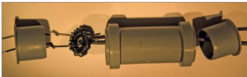
Här har spartrafon redo att förpassas i skarvmuffen (40 mm) av plast. Notera antenntrådets dragavlastning i form av en knut. Koaxdelen (till höger) dragavlastas mot locket med två hårt dragna buntband kring kabeln.
