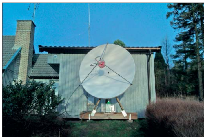
SM6PGP:s 1,8 m parabol för EME.
