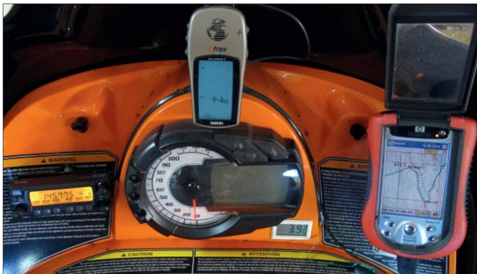
Radiofront, GPS samt handdator med kartmotor monterat framför styret.
