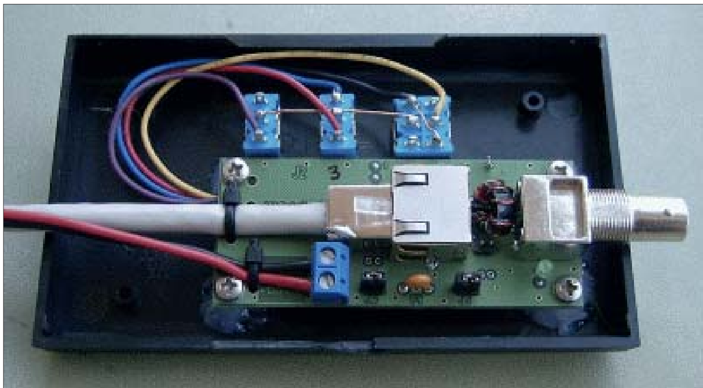
Kontrollkortet används för att styra och spänningssätta förstärklådan. Den balanserade signalen transformeras till obalanserat för koaxen mot radion. På bilden monterat i en passande låda. Alla bilder från LZ1AQ material.
