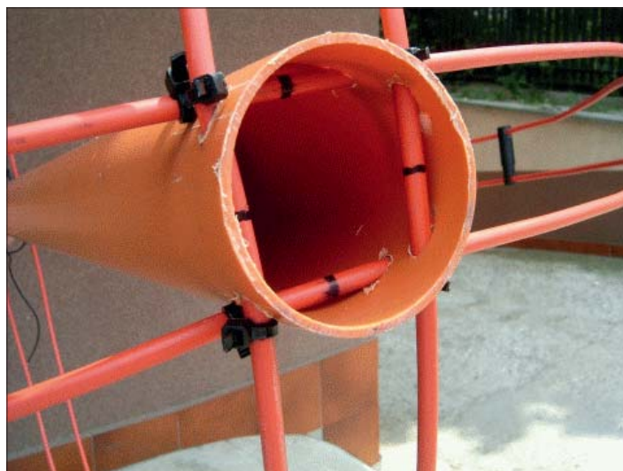
Så här ser exemplets antenntår ut då dom möts i masttoppen. Enkelt och kul att bygga. Hitta på din egen lösning.
