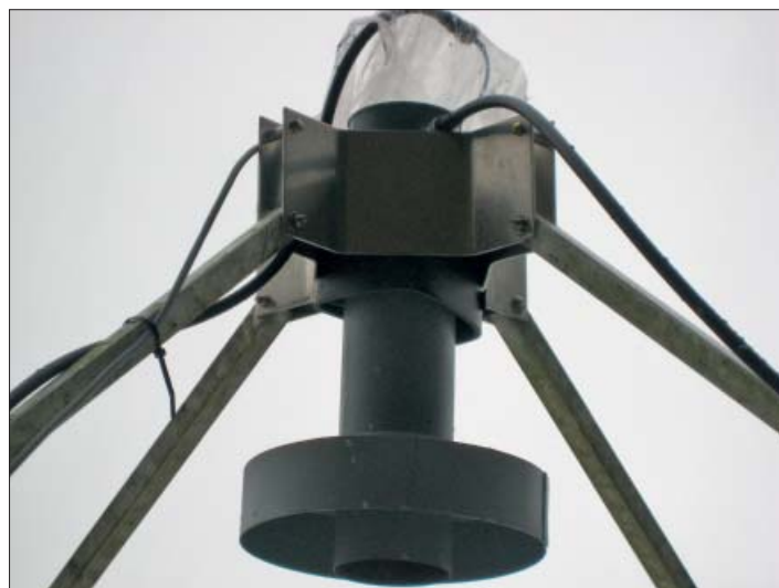
Feedhorn med preamp och isolationsrelä.
