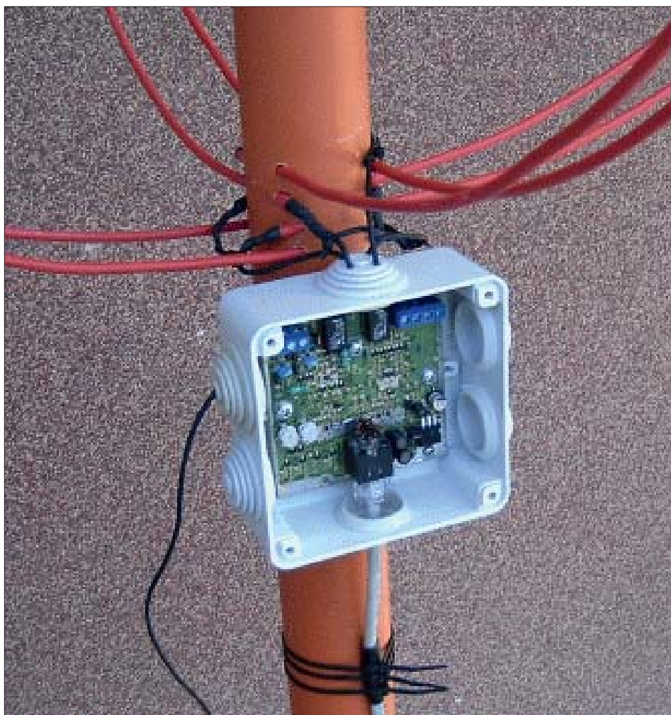
I den vita lådan sitter flera förstärkare så att vi kan koppla in upp mot tre antennelement, att använda för att gräva efter den där signalen vi inte trodde fanns.
