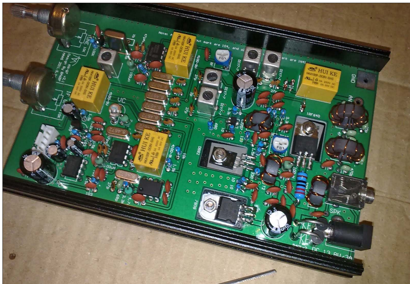
Tittar man under loket ser vi ett prydligt inre. Vi känner igen potentiometrar för avstämning och förstärkningsreglering. Kristallfiltret med sina 6 kristaller och ett antal IC-kretsar för blandare och förstärkning syns också. Synnerligen lätt att bygga och att lyckas med.
