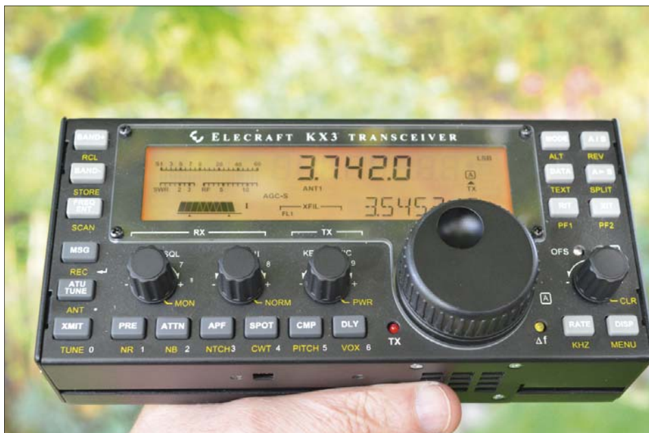
En hand full ganska liten radio med rent otroliga prestanda. Displayytan är den samma som storebror K3. Övriga knappar har alla minst dubbel funktion. Man kommer dock snabbt underfund med vad som skall göra.
