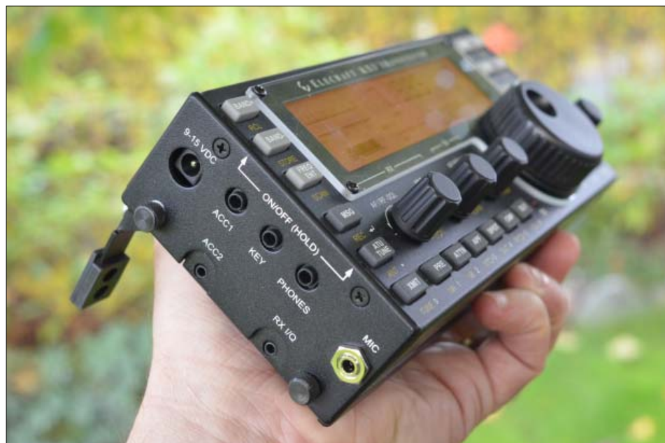
På kortsidorna sitter kontakterna frö anslutning till omvärlden. Alla kontakter är jack med 2.5 eller 3.5 mm diameter. Kanske inte det mest robusta för fältbruk men platsbristen påkallar denna lösning. I bakkant ses ett av benen som kan fällas ut för att få en bra arbetsvinkel.
