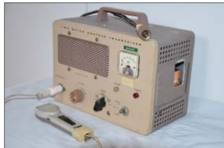
Den gamla HW-30:n som jag lånade av SM6DTC och använde som mobil sändare. Moddad med antennrelä och PTT. PL-kontakten anslöts till ELFA-konvertern.
