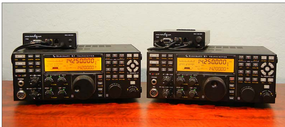
Elecraft [1] och Remoterig [5] i skön förening. Vad sägs om att fjärrstyra en K3:a över nätet med en annan K3:a? Vill du inte har en fullbestyckad i operatörändan, så finns det en tom variant som heter K3/0 – fungerar som terminal då. Bild: Elecraft
