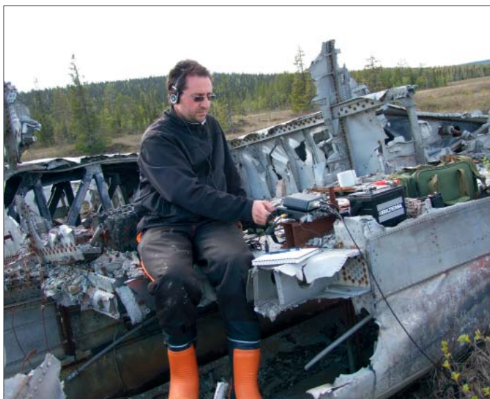
Vid radiooperatörens plats. Besättningen satte eld på planet efter nödlandningen. Enligt de instruktioner de fått, för att inte planet skall kunna användas av främmande makt. Det syns väl hur aluminiumet har smält.
