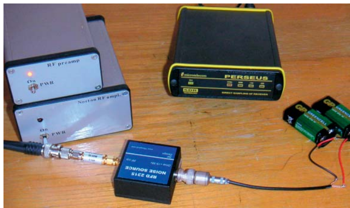
Brusällan (RFD 2315) är kopplad via de två förstärkarna till Perseus-mottagaren. Förstärkarna har inbyggda reläer som kopplar signalen vidare om de inte är inkopplade (power ON). RFD 2315 matas med 18 V via två seriekopplade 9 V batterier (den drar bara cirka 15 mA). En 10 dB dämpsats är inkopplad för att kompensera för Nortonförstärkarens förstärkning. Perseus ansluts till datorn via USB-bussen.
