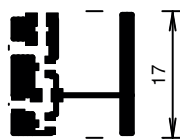
Fig 2, mönsterkort för sidobestämningsantennens förstärkare (rättvänt).
