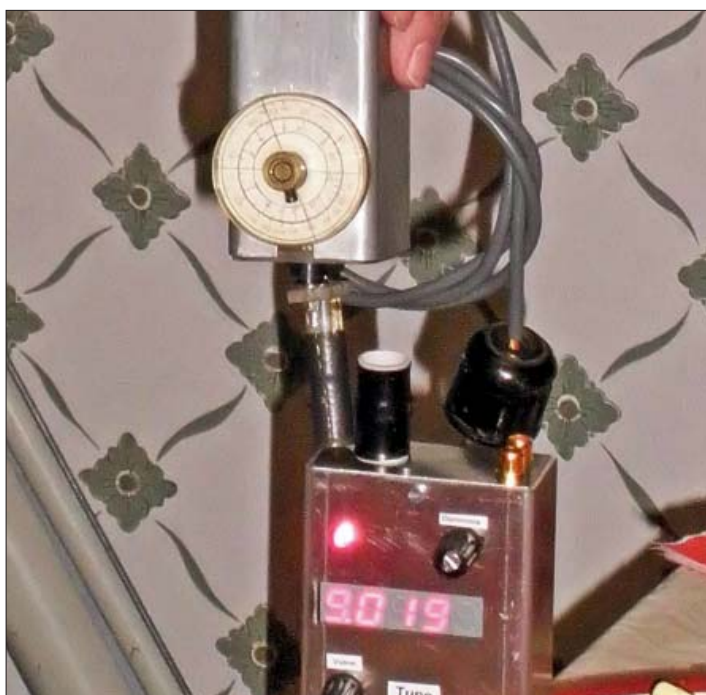
Vid vår Glöggkväll den 14 december så förevisades apparaten inför en fullsatt klubbstuga. Som mätobjekt hade Börje med sig en gammal griddippa byggd av SM6PU (SK). Bilden bevisar att det fungerar, vi lyckades!
