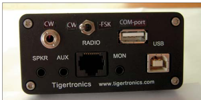
På baksidan tillkom jack för CW-nycklingen av riggen. Strömbrytare för att koppla bort RTS som Bertil använder till annat när han kör programmet Echo-CW (manipulator direkt kopplad till 9-poliga D-sub:en). Utgång för anslutning till COM-port på dator.
