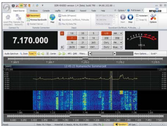
En skärmbild av SDR-radio konsol, användargränssnittet för att köra en lokal eller "remote" SDR-mottagare. Läs i text om delar av funktionen.
