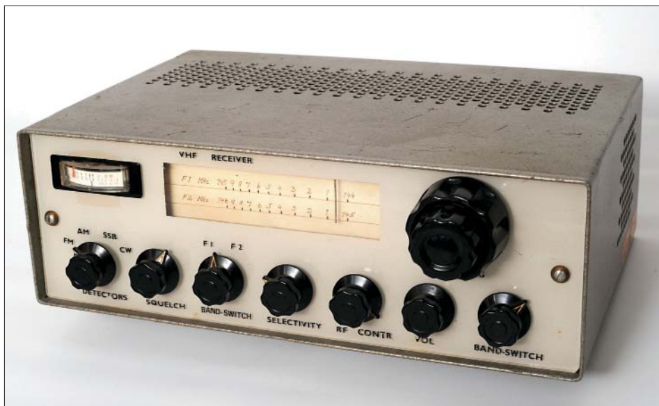
SM7DEZ Rolfs mobilmottagare för FM, AM, SSB samt CW. Foto: SM6JXX, Lennart.
