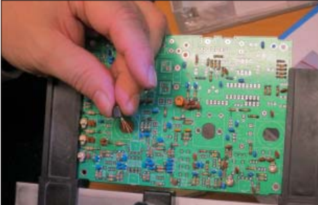
Nu har vi kommit en bra bit på väg och det är nu dags för montering av spolar till blandaren.
