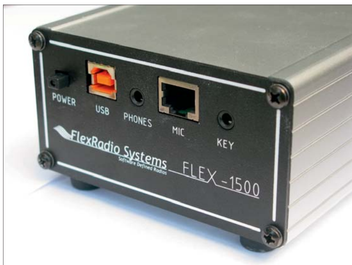
FLEX-1500 Framsida: På "framsidan" kopplas som synes hörtelefon, CW-nyckel och mikrofon. Till den sistnämnda kan en vanlig YAESU mikrofon för exempelvis FT-817 användas. Här kan man även använda exempelvis en dynamisk mikrofon. USB-snittet används för kommunikation med PC:n. Bild: JZT
