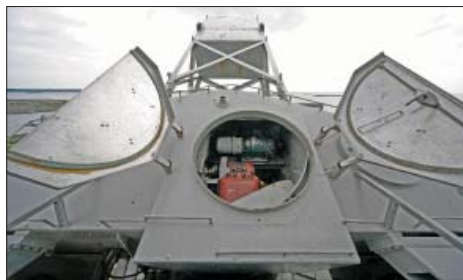
Här kryper vi upp ur tornet. Det röda är elevationsmaskineriet och allt är oljigt! Foto: SM6GUS
