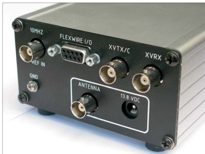
FLEX-1500 Baksida: Kontakterna talar egentligen sitt tydliga språk. Som framgår kan man ansluta en högstabil yttre referensoscillator (10MHz). Kan vara lämpligt då man vill köra transverterdrift på UHF-banden. "FLEXWIRE"-kontakten innehåller ett antal styrsignaler som kan vara bra att ha. Bild: JZT
