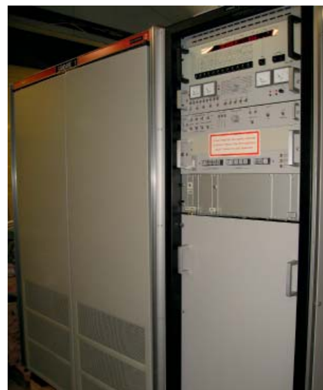
Ett par bilder av kortvägssändaren i Sala. Den består av en styrsändare TD90 från Svenska Standard Radio & Telefon (SRT f.d. ITT) som följs av ett linjärt slutsteg Collins 208U-10A som ger 10kW uteffekt. Mera information om utrustningen i Sala hittar du på: www.nybergsala.com Foto: Bernt Nyberg.
