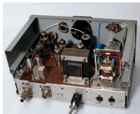
Till höger syns tunern från Görler skymta fram bakom LF-förstärkaren. I mitten sitter modulatorn med sin stora modulationstransformator i bakkant. Till vänster sändaren med QQE03/12 längst fram mot panelen. Foto: SM6JXX.
