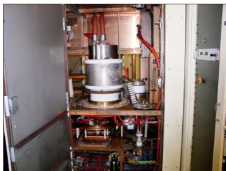
Slutröret med 500 kW uteffekt i kortvågssändarna. Ett slutrör i varje sändare.
