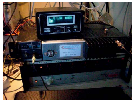
Mellanvågsexcitern som användes vid sändningarna från Kvarnberget på 1512 kHz. Vid detta tillfälle lyckades vi kräma ut mer än 1 kW ur sändaren. Ingemar har för övrigt restaurerat en hel del av de gamla originalband som kördes i sändningarna och många inspelningar kan avlyssnas via hans webb Svenska Radioarkivet. Foto: Ingemar Lindqvist.
