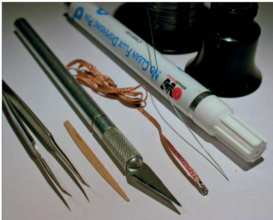
Bra verktyg är halva jobbet. Men det behöver vara varken dyrt eller svårt att få tag i. Från vänster till höger ser vi: En högkvalitativ pincett, tandpetare, skalpell, avlödningsstrumpa lödtenn, flussmedel i penna och en urmakarlupp med cirka 10 gångers förstoring. Se även text för detaljer.
