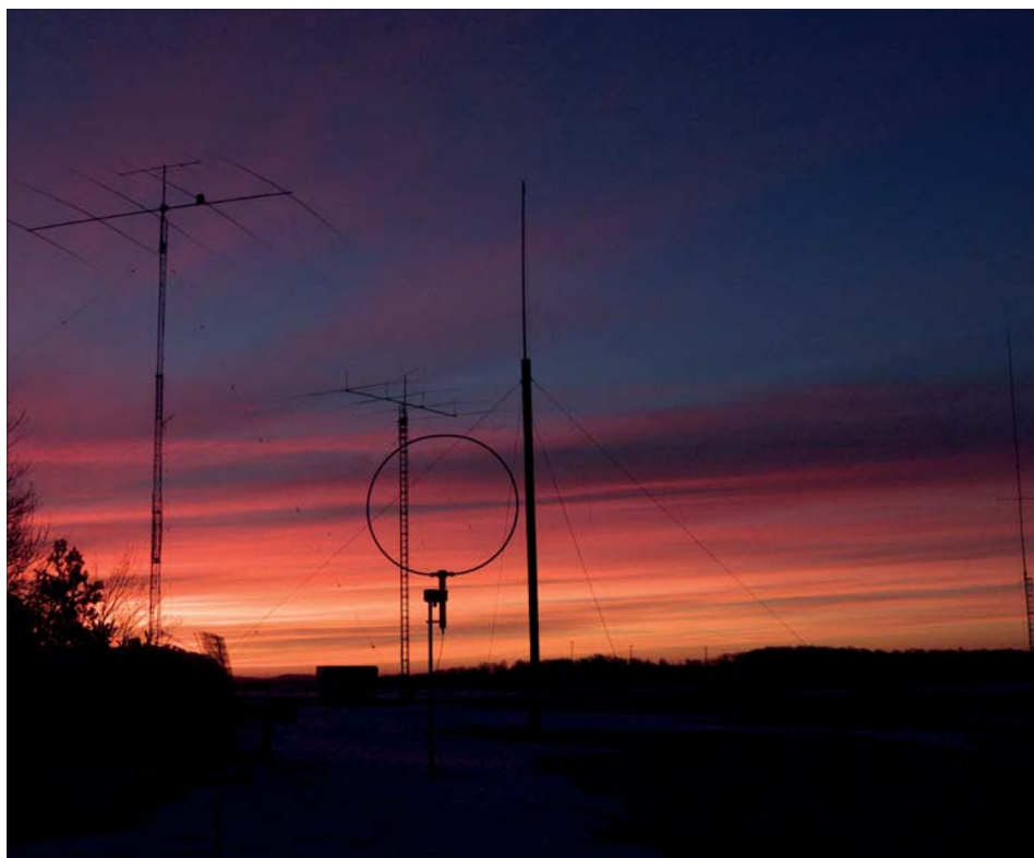
Här ser vi från vänster Wersatower med en monobandare för 20 m, 4 element för 40 m, magnetisk loop för lyssning på 160 m, K9AY lyssningsantenn samt längst till höger en 39 meters GP för 160 m.
