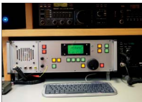
SM4DHN, Lars-Bertil's nya fjärrstyrningsradio. I grunden är det en förklädd 706.a.
