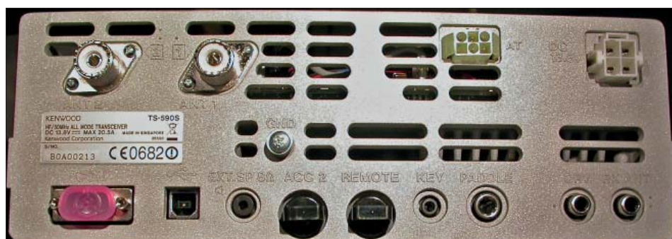
Baksidan medger inte bara inkoppling av två antenner. Här finner vi även mera exotiska kontakter som USB, transverter (DRV) och inkoppling av separat mottagarantenn.
