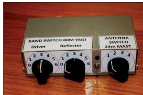
Manöverboxen. Separat switchning på elementen ger möjlighet att testa olika konfigurationer samt flytta antennen i frekvens.
