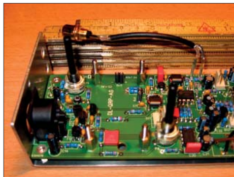
5 cm coax kabel som borde vara 10 cm!
