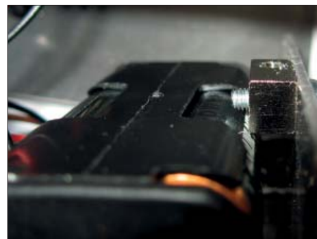
Här syns tydligt hur batteriet kortsluts, HU!
