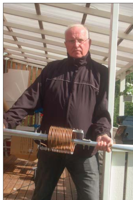
SM5FQQ visar upp förkortningsspole för 80m.
