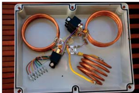
Switchlåda, denna för drivelementet med matchningspolen nederst till höger. Bilreläer används på SM5SCSS manér.
