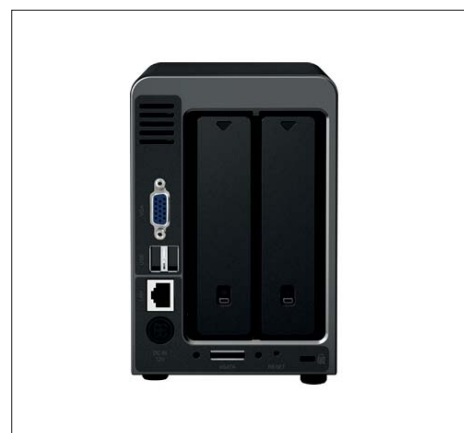
DS710+ på framsidan återfinns 1 USB-port och indikatorer och strömbrytare. På baksidan återfinns 1 RJ45 LAN-port, 2 USB-portar, 1 port för eSATA, 1 konsol-port som för närvarande endast används i samband med fabriks-tillverkningen samt anslutning av strömförsörjning.
