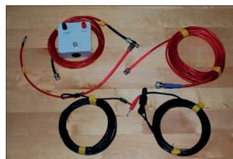
Ingående delar till en stubbantenn för 7 och 14 MHz. Dosan är en enkel kopplingsdos.
