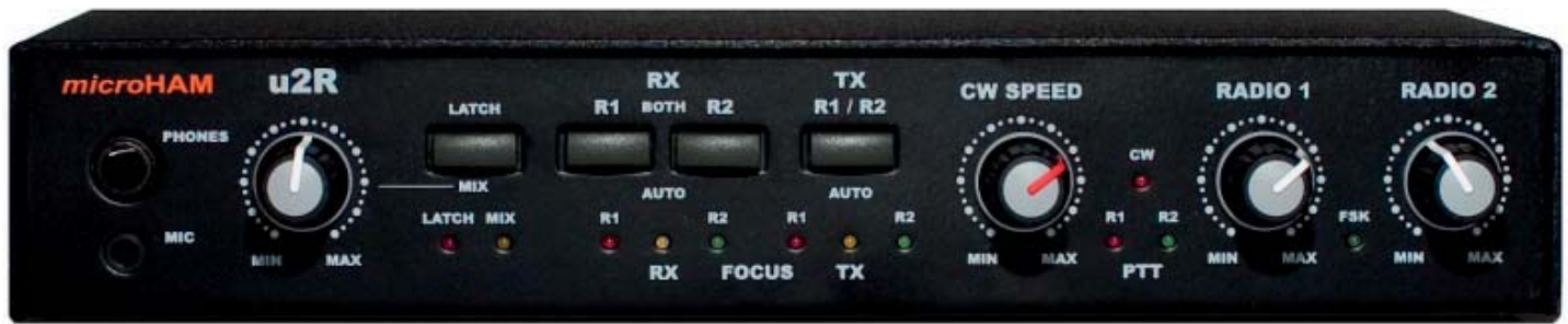
micro2R från microHam. En enklare variant av SO2R-box som innehåller all omkoppling, men inget ljudkort eller CAT-styrning.
