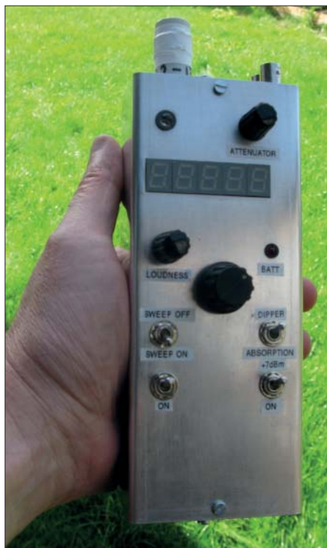
Så här ser DipIT-griddippan ut när den är klar för drift. Läs mera om konstruktionen i QTC 7-8. Detta exemplar har Anders SM0HPL byggt och satt sin prägel på.
