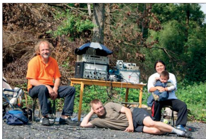
TUNG portabelstation SL5FHT/6P. Sittande sändarskötare Jonas och liggande operatör Bjarne (SA5AIX) Second op's Viloeta och Siomon. Platsen är en skogsdunge utanför Grimeton-Varberg Sändare CTD 500 från SRT. Effektförstärkare ENI, gav 40 W pga att elverket inte orkade ge mer. Mottagare Mt600, antenn dipol 2 x 19 m. Barnvagnsparasoll ger extra skugga!
