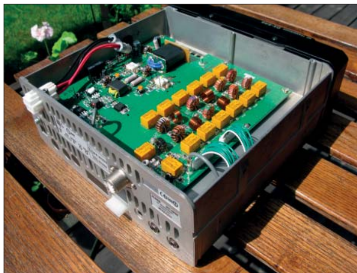
Här ser vi djupt ner i lådan efter slutsteg och lågpasfilterdelen. Gott om plats och ren uppbyggnad. Kontakterna inskränker sig till de grundläggande.
