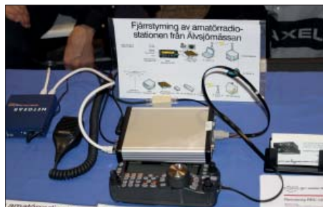
Fjärrstyrning av transceiver över internet med hjälp av enheter från Microbit i Kalix. Man behöver inte ge upp amatörradion på grund av lokala störningar..
