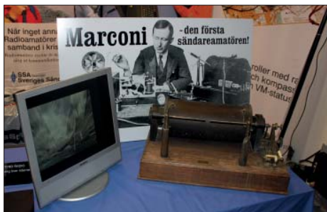
Marconi var den första sändareamatören. Här visades en animerad film om den första transatlantiska förbindelsen år 1901 och den typ av gnistsändare, som Marconi använde i sina första experiment.
