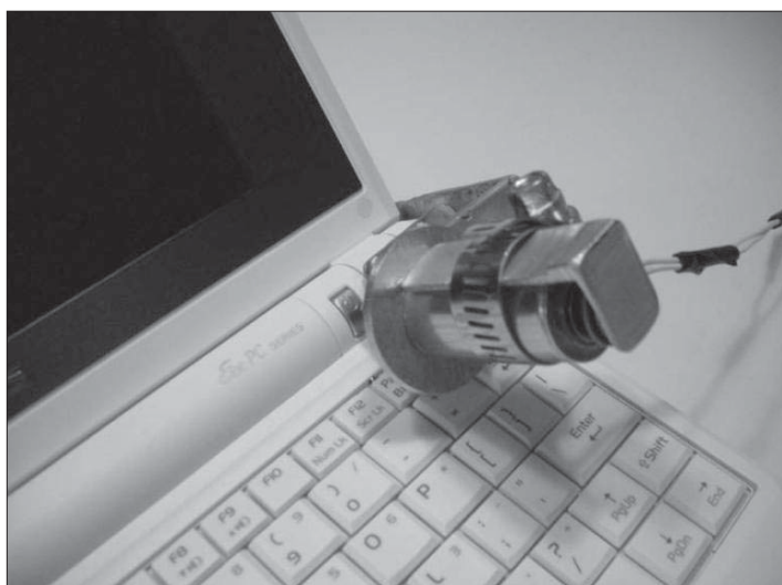
Av och påslagning av den fjärrstyrda datorn med hjälp av en solenoid! Kanske inte den mest uppenbara lösningen? Foto K6VVA.
