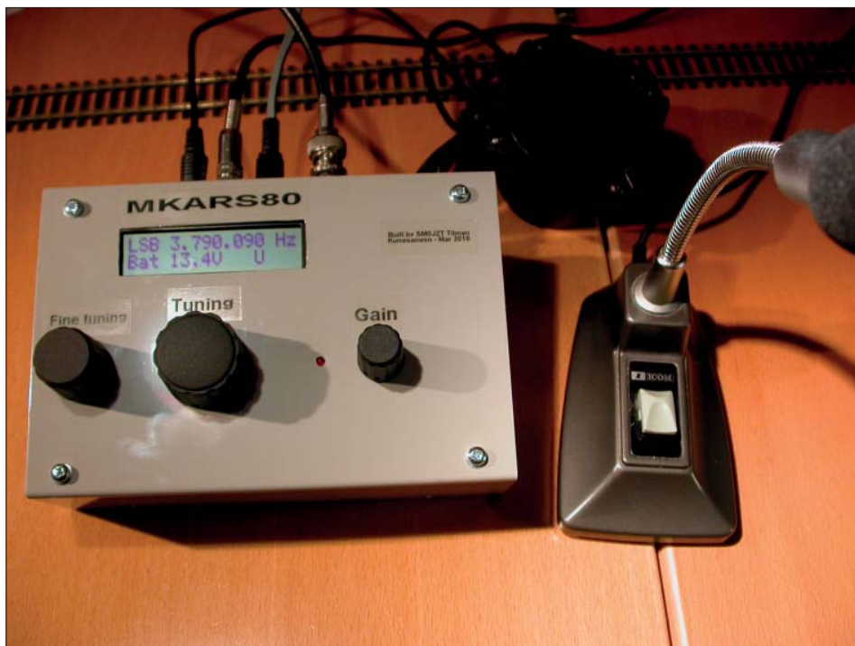
MKARS80 front.: Så här ser den MKARS80-rigg ut som byggts av SMOJZT. Alla hål måste göras av byggare själv. Noggrannhet och tålmod anbefalles för att det skall se bra ut. Texten har gjorts med en DYMO-apparat på genomskinlig film.
