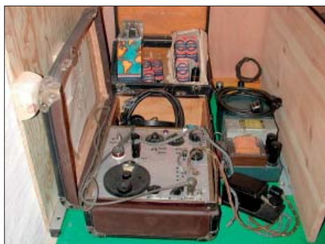
Lagercrantz-settet från station MU Hans M Hansen TXX-talstyrt cirka 25 watt endast för telegrafi. På frontpanelen finns en switch märkt 3384 respektive 7007. det kan vara xtalfrkvenserna. Rör 6V6 och 807.
