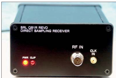
QS1R-mottagaren är en så kallad SDR-mottagare. På andra sidan av lådan finns USB-anslutningen till PC. Foto: N8VB.
