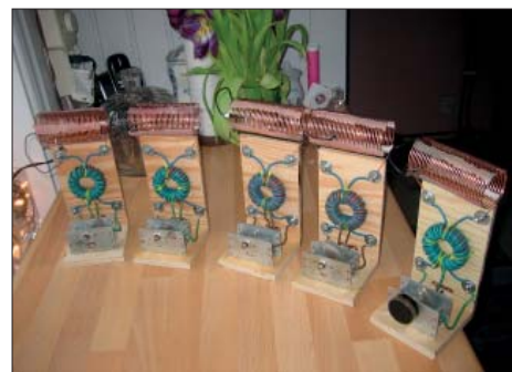
Fem stycken prefabricerade S-matchar. Spolarna är gjorda av EK1,5 och stuvade i vanliga papptuber för ritningar under resan. Träplattorna med induktans resp vridkondensator delades för att lättare kunna packas under resan. Väl framme monterade jag ihop dessa och fäste spolen i plattans överkant med smältlim.
