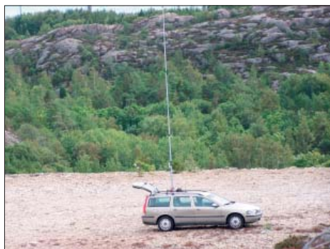
SSA portabeltest med SA6AHL. Antennen uppsatt med glasfiber-teleskopmast.
