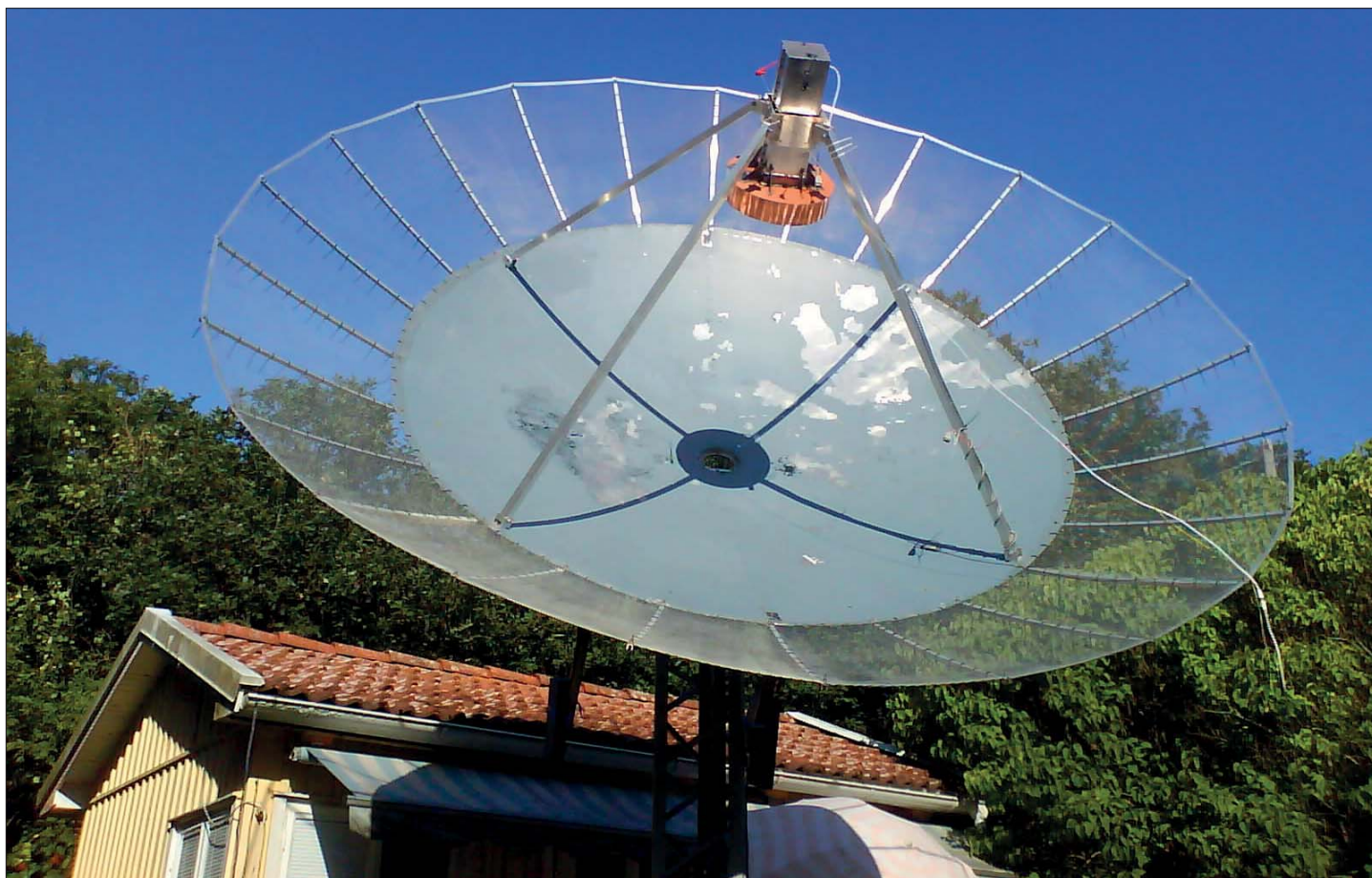
Utbyggd 4 m parabol med matare riktad mot solen, vilket framgår av skuggan.
