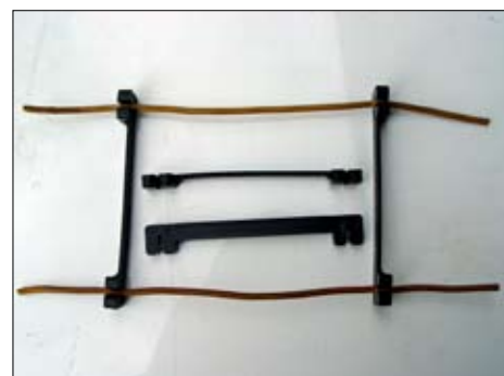
Stegpinnarna visas lösa men också med en FK 1,5 intryckt. Totallängd är 100 mm och mellan trådarna 80 mm. Max tråddiameter är 2 mm.
