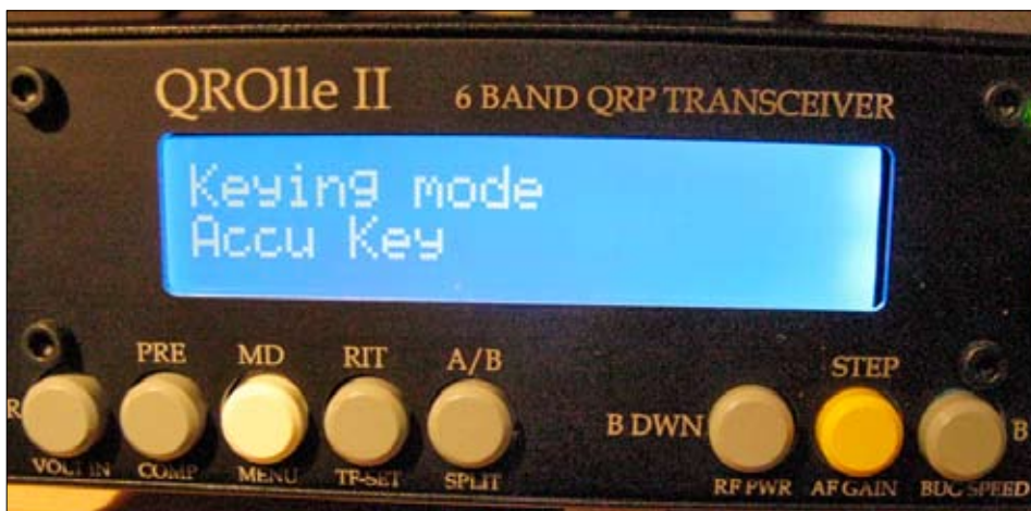
QROlle har nu en uppdaterad programvara, som bland annat ger stöd för accukeyer. Bild SMOJZT Tilman.
